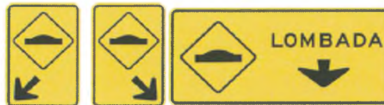
Figura 54. Sinalização de advertência aplicada em lombadas.
