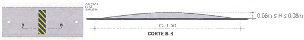
Figura 53. Dimensões de ondulação transversal tipo B.
