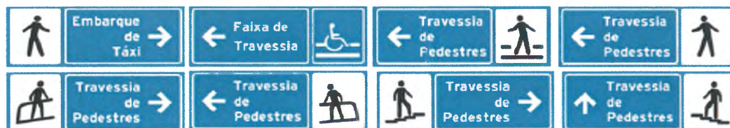
Figura 40. Placas de serviços auxiliares para pedestres.
