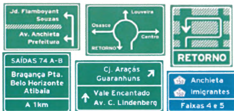
Figura 37. Placas de orientação de destino.
