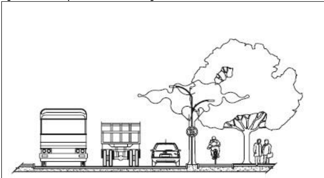
Figura 16: Corte esquemático de uma via segura
