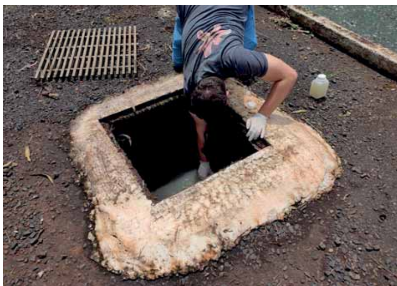
Figura 78 – Coleta de amostra do Esgoto na entrada da ETE
