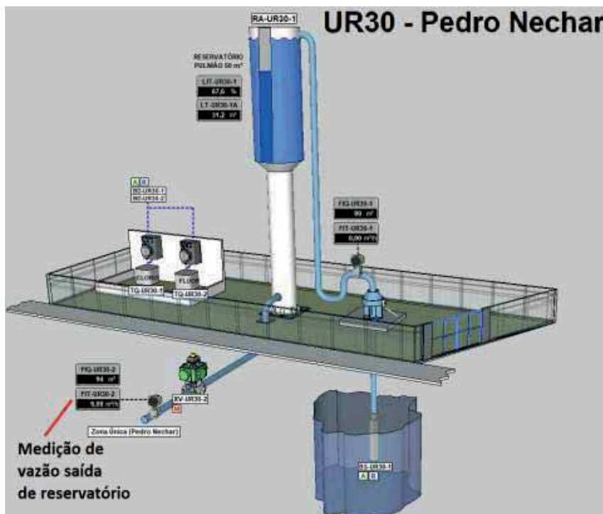
Figura 2: Exemplo de uma tela do sistema supervisório da SAEC. Monitoramento em tempo real da vazão de saída do reservatório para o abastecimento da população.
