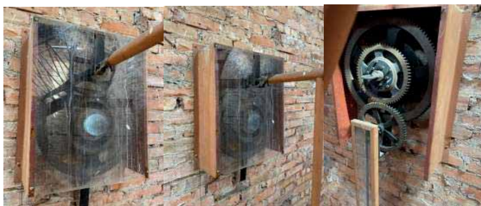
Engrenagens que movem os ponteiros, uma em cada face
