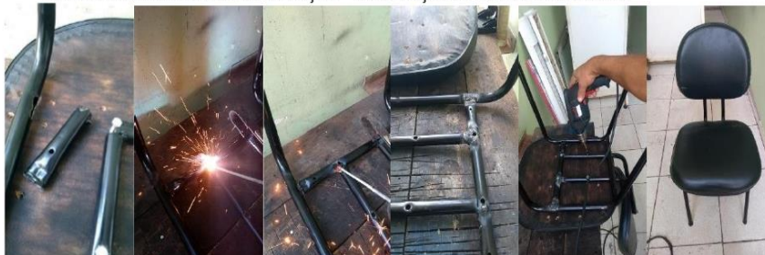
AGOSTO/2022: reforma/manutenção – Manutenção e soldagem de cadeiras e longarinas de diversos setores da unidade.
