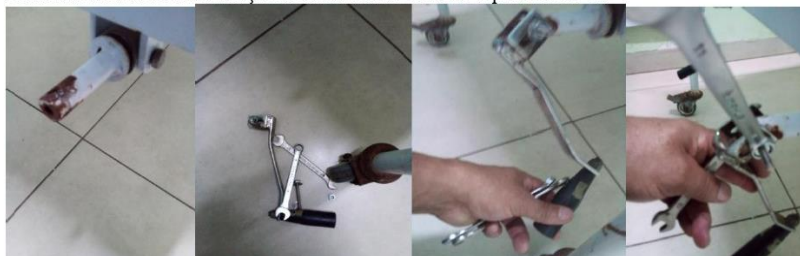
DEZEMBRO/2022: Manutenção na manivela da cama do repouso leito 07
