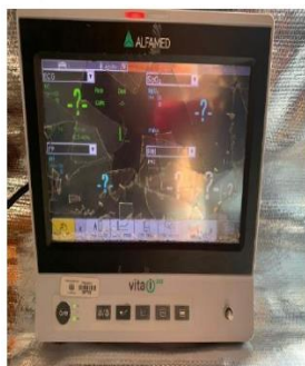
4-REPARO EM MONITOR ALFAMED (QUEDA)
