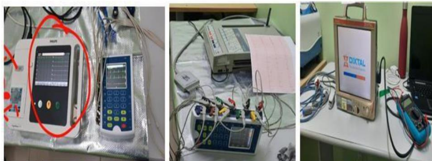
1-INTERFERÊNCIA ECG OBSERVAÇÃO 'BATERIA' 2-TESTE C/ ANALISADOR ECG 3-REPARO DE MONITOR OBSERVAÇÃO
