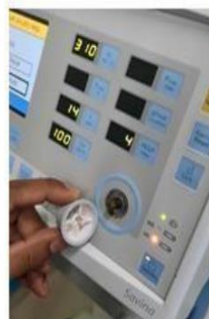
6-BOTÃO QUEBRADO VT
