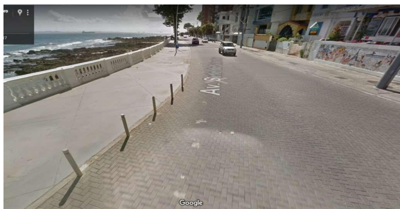
Imagem 7 - Pavimento Intertravado (exemplo)
