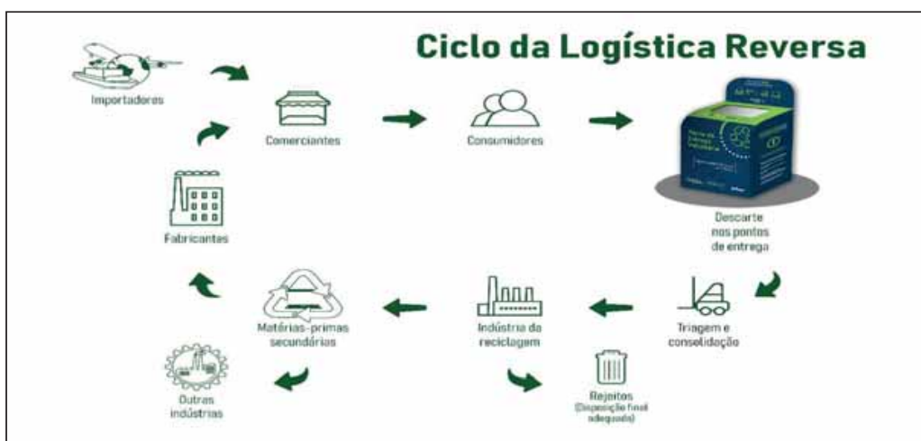
Figura 73 - Ciclo da logística reversa dos eletroeletrônicos e seus componentes.
