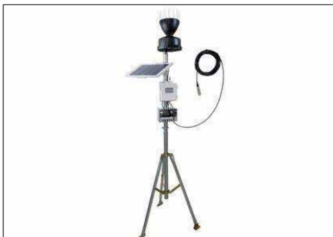
Figura 160 - Exemplo de estação Fluviométrica Automática.
