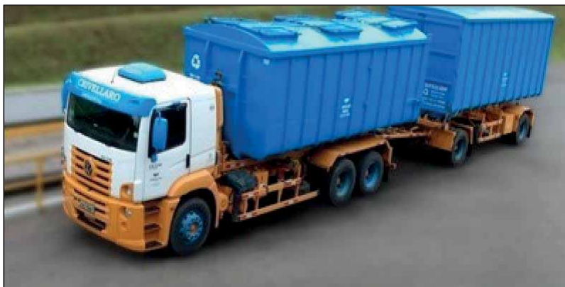
Figura 142 - Veículo utilizado para o transporte de lodo de ETA / ETE.
