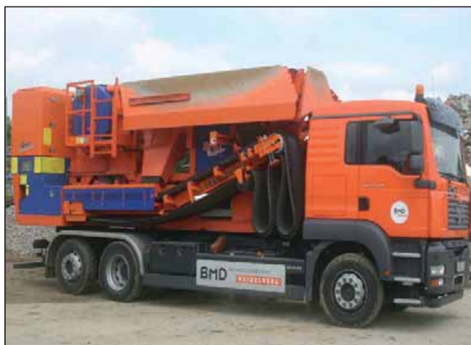
Figura 141 - Usina móvel de RCC.
