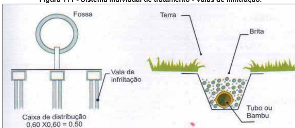
Figura 111 - Sistema individual de tratamento - Valas de Infiltração.
