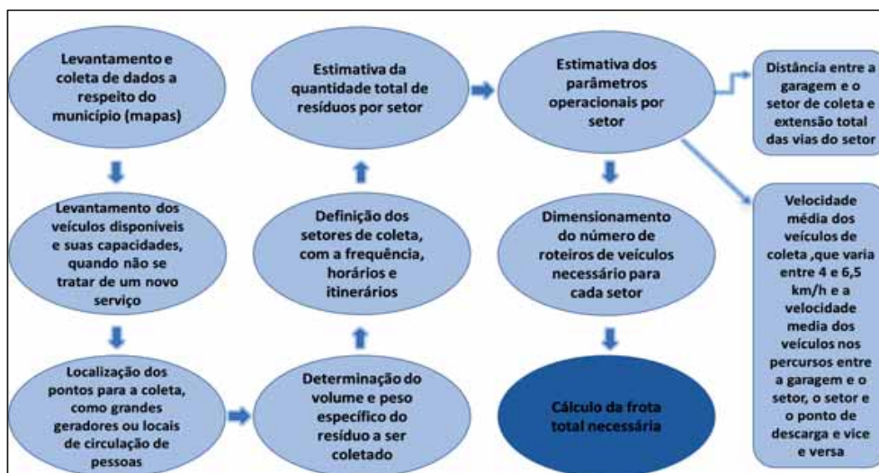
Figura 132 - Fluxograma das etapas mínimas do dimensionamento da coleta convencional.
