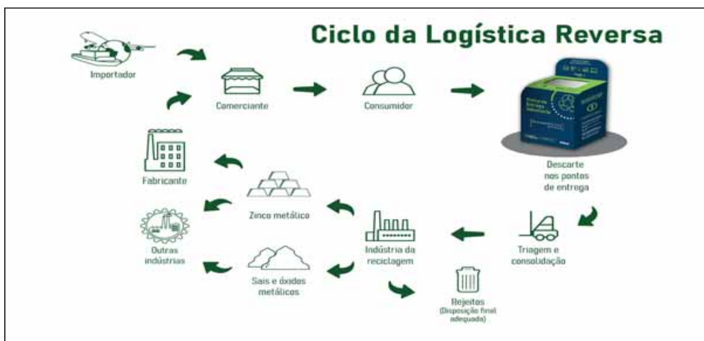
Figura 74 - Ciclo da logística reversa de pilhas e baterias.
