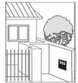
1) Instalação da caixa em terreno ou quando o fechamento da fachada da residência for feito por grade ou similar, em vez de muro: Deverá ser construído um trecho em alvenaria para instalação da caixa, garantindo o livre acesso da D.A.E ao hidrômetro.
