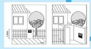
1) Instalação da caixa em terreno ou quando o fechamento da fachada da residência for feito por grade ou similar, em vez de muro: Deverá ser construido um trecho em alvenaria para instalação da caixa, garantindo o livre acesso da D.A.E ao hidrômetro.
