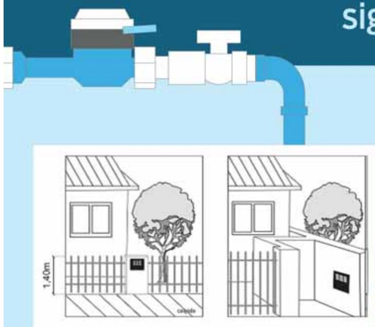
**1) Instalação da caixa em terreno ou quando o fechamento da fachada da residência for feito por grade ou similar, em vez de muro:** Deverá ser construído um trecho em alvenaria para instalação da caixa, garantindo o livre acesso da D.A.E ao hidrômetro.
