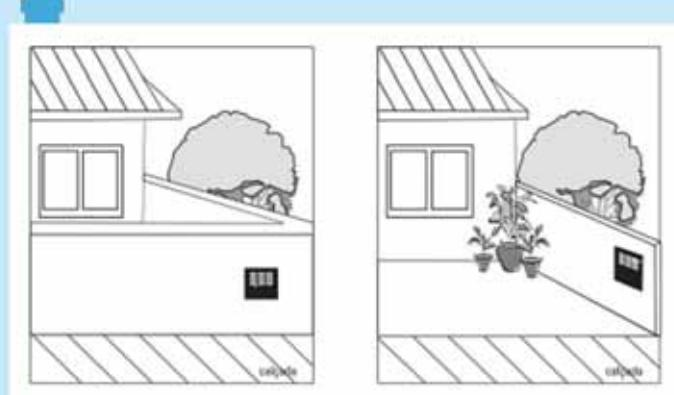
**2) Instalação Lateral:** Para instalação lateral será necessário deixar um recuo no muro ou grade frontal para garantir o acesso ao hidrômetro pela calçada. A largura deste recuo deverá ser no mínimo de 01 (um) metro e ainda permitir a abertura total da tampa.
