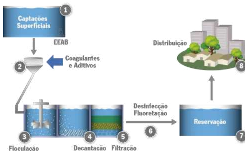
Figura 4-7 – Esquema representativo do tratamento de água na ETA Sede de Laranjal Paulista/SP
