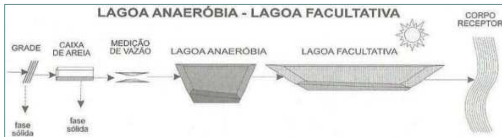
Figura 5-8 – Esquema do tratamento de esgoto de Laranjal Paulista/SP.
