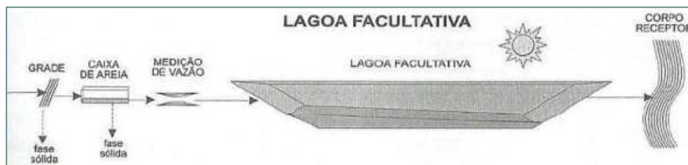
Figura 5-12 – Esquema do tratamento de esgoto no Distrito Laras em Laranjal Paulista/SP.
