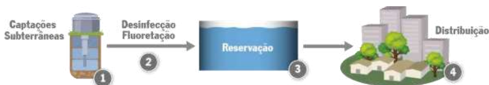
Figura 4-13 – Esquema representativo do tratamento de água do distrito de Laras
