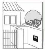
1) Instalação da caixa em terreno ou quando o fechamento da fachada da residência for feito por grade ou similar, em vez de muro: Deverá ser construido um trecho em alvenaria para instalação da caixa, garantindo o livre acesso da D.A.E ao hidrômetro.
