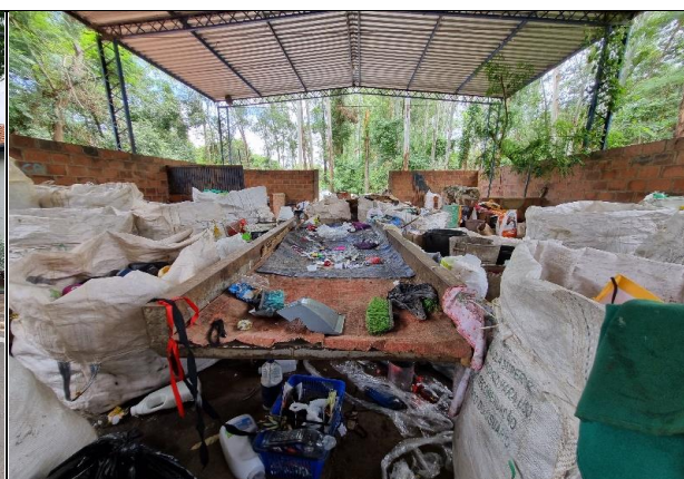
Foto 18: Galpão de triagem de resíduos passíveis de reciclagem – mesa de triagem manual (25/10/2023).
