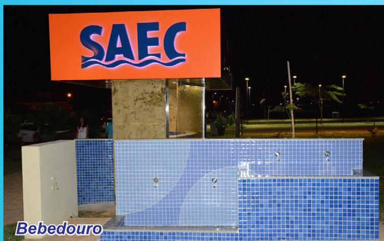
*A estrutura do bebedouro é em concreto armado, com laje balanceada envolvida por platbanda em alvenaria, revestida de alumínio composto em laranja. O logotipo da Superintendência de Água e Esgoto de Catanduva (SAEC) é revestido com alumínio composto com luzes de neon. A obra é composta por alvenaria revestida de pastilhas de primeira qualidade, cerâmica da cor azul e acabamento de granito. Um refrigerador mantém a água gelada, em cima, com bombas e encanamentos na parte inferior.*
