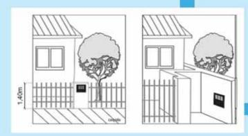
1) Instalação da caixa em terreno ou quando o fechamento da fachada da residência for feito por grade ou similar, em vez de muro: Deverá ser construído um trecho em alvenaria para instalação da caixa, garantindo o livre acesso da D.A.E ao hidrômetro.
