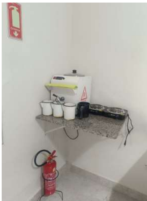
Equipamentos elétricos para derretimento de parafina.
