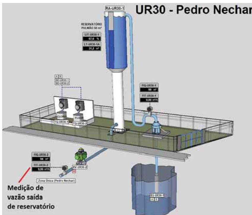
Figura 2: Exemplo de uma tela do sistema supervisor da SAEC. Monitoramento em tempo real da vazão de saída do reservatório para o abastecimento da população.
