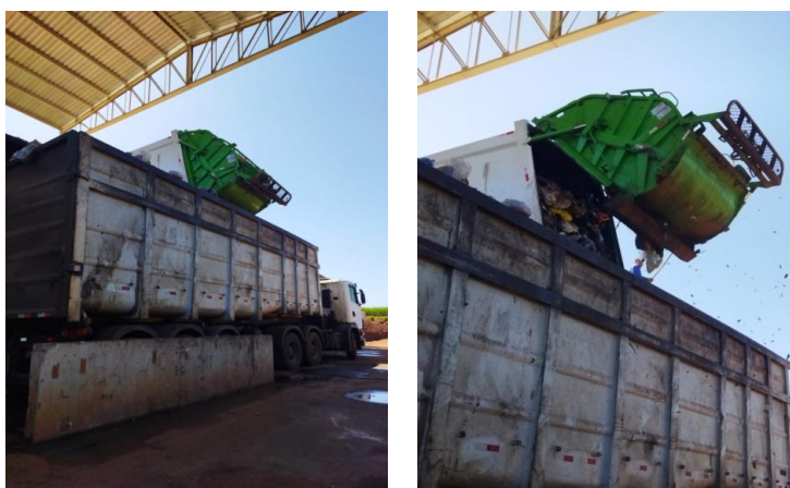
Figura 111: Transferência dos resíduos para as carretas que realizam o transporte até o Aterro Sanitário
