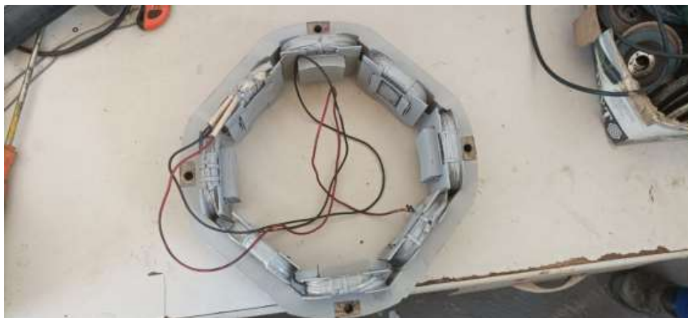
Figura 1: Excitatriz a ser rebobinada por completo.
