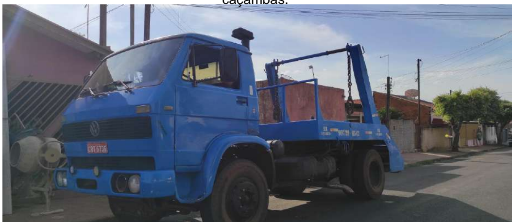
Figura 20: Poliguindaste de empresa locadora, utilizado para transporte de caçambas.
