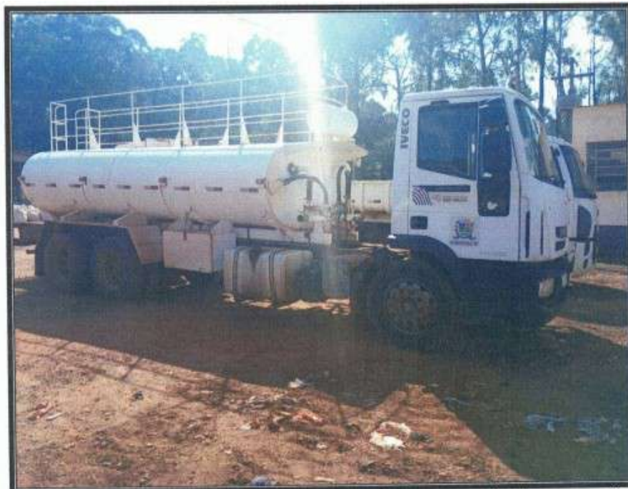
Figura 11: Caminhão utilizado para umidificar os acessos do aterro evitando a suspensão de materiais particulados finos
